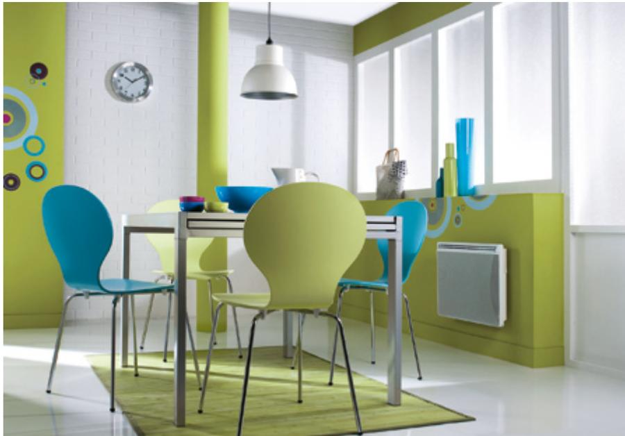
Este fenómeno lo evitan los convectores radiantes que disponen de una construcción que permite entregar hasta cca un 50 % de la energía térmica por radiación y cca un 50 % de la energía por convección, conservando así una dinámica perfecta de la calefacción y calentando a la vez las construcciones mediante la radiación del convector. Por eso su servicio es bastante más confortable y en las habitaciones de vivienda debería preferirse su uso.
