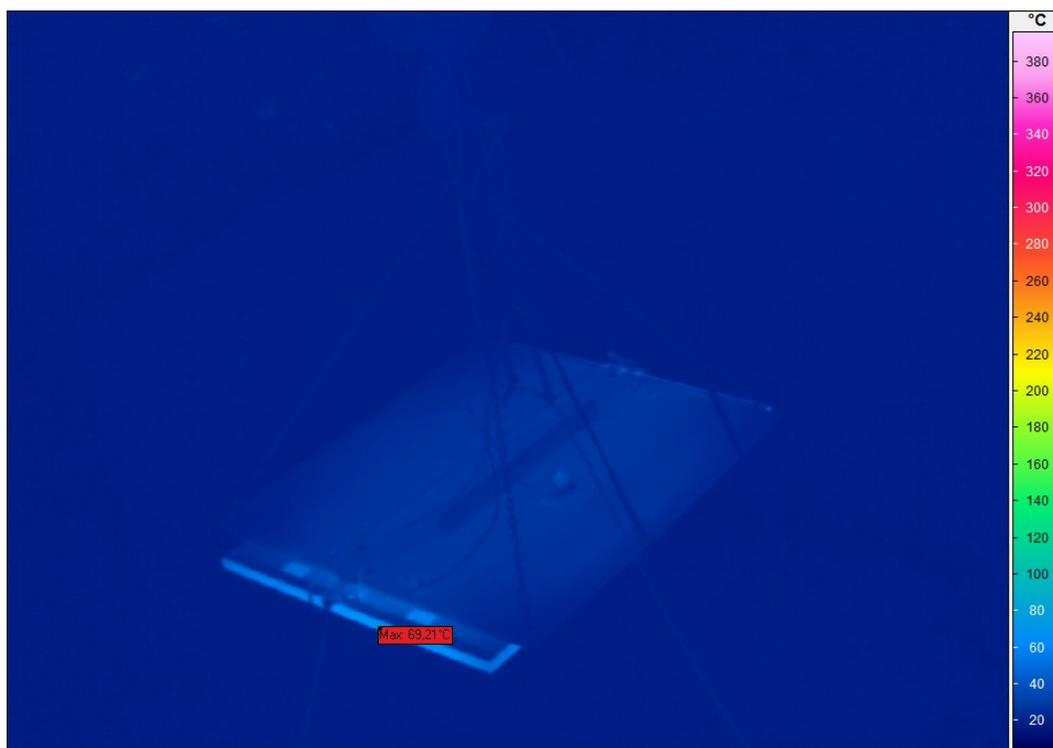
Obr. 3-24 Termosnímky povrchových teplot čelní plochy a zadního krytu panelu Ecosun 1000 U
