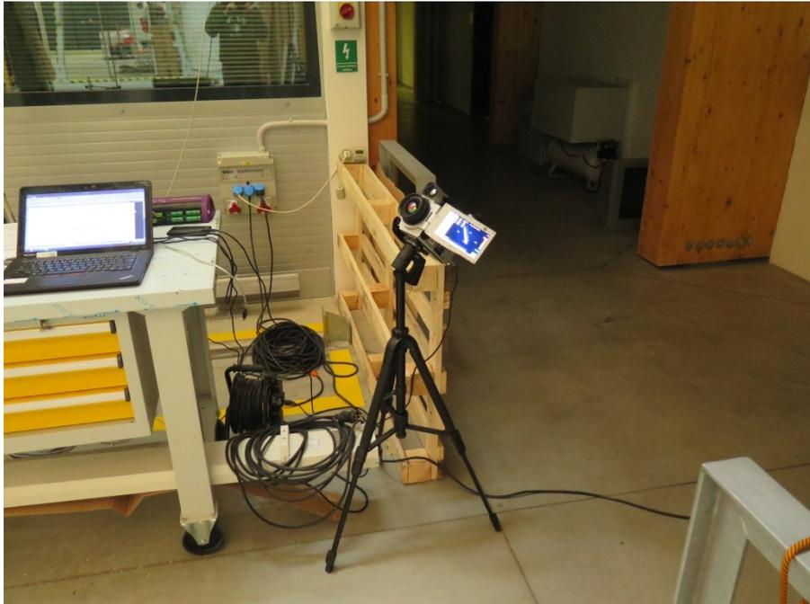
Obr. 4-6 Termokamera VarioCam použitá pro stanovení povrchových teplot panelů
