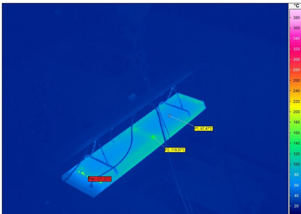
Obr. 3-18 Termosnímky povrchových teplot čelní plochy a zadního krytu panelu Ecosun S+ 36
