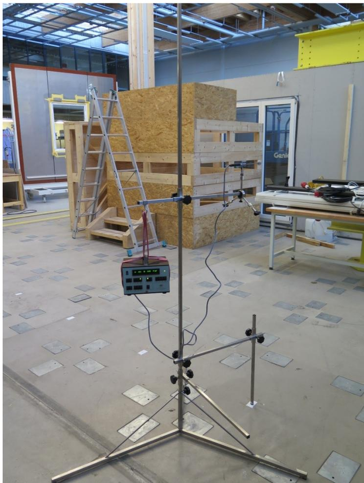
Obr. 4-4 Stativ s čidlem pro měření radiační asymetrie a ústřednou v jednom z bodů měřící sítě (bílé značky na podlaze)
