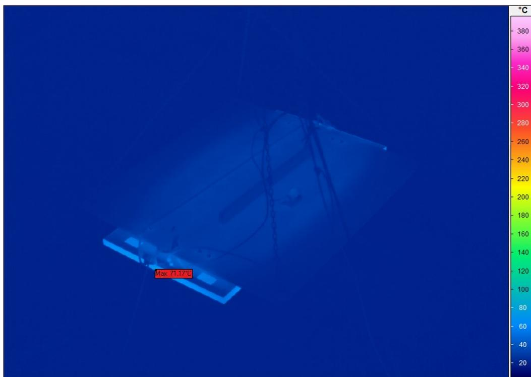
Obr. 3-21 Termosnímky povrchových teplot čelní plochy a zadního krytu panelu Ecosun 700 U
