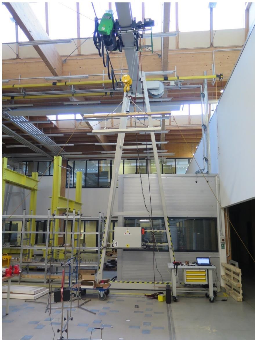
*Obr. 4-1 Sálavý panel Ecosun zavěšený na jeřábové dráze v místě měření*
