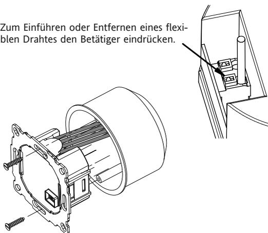
Die Drähte müssen so montiert werden, daß der Plastikstreifen als Isolation zur Befestigungsschraube wirkt.
