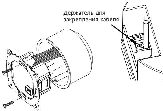
Обязательно необходимо установить пластиковую рамку, чтобы обеспечить изоляцию между выходами/проводами и крепежными винтами.
