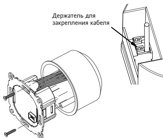
Обязательно необходимо установить пластиковую рамку, чтобы обеспечить изоляцию между выходами/проводами и крепежными винтами.
