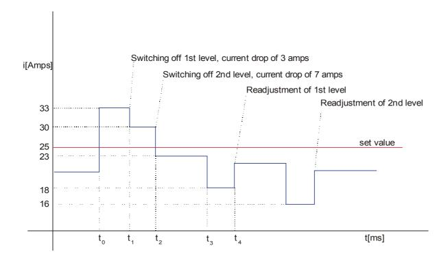
$t_1 - t_0 = t_2 - t_1 = 200 \text{ms}$  $t_4 - t_3 \le 200 \text{ms}$
