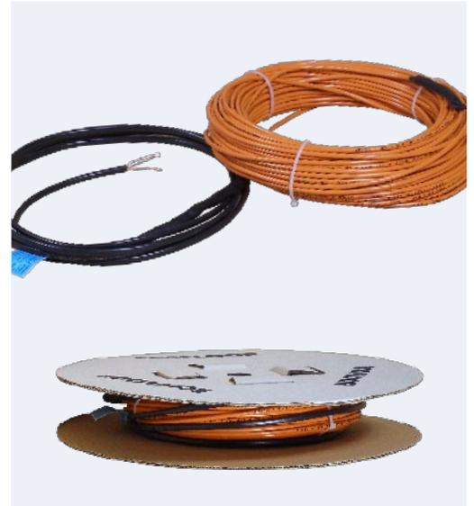
► **Heizkabel ADPSV** – zweiadriges Kabel mit voller Schutzumflechtung, für Fußbodenheizung mit voller Speicherung oder Halbspeicherung in Wohnräumen geeignet. Klasse M2. Anschlusskabel – kaltes Ende 1×5 m. Ø 5,3–5,9 mm. 230 V.
