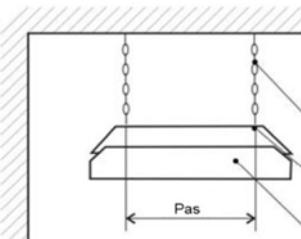
Les pas des pièces de fixation sur la partie arrière du panneau : Les pièces de fixation insérées, il est conseillé de bloquer leur position contre une mise hors de la position par les vis de réglage.
