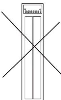
Le panneau rayonnant peut être installé incliné ou perpendiculaire, mais jamais la réglette à bornes ne peut se trouver au point le plus haut du panneau. Dans une inclinaison, la convection de la chaleur est augmentée et la chaleur endommagerait irréversiblement les dispositifs électriques de la réglette à bornes.
