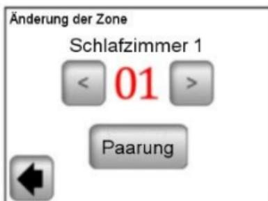
Zwecks einfacherer Orientierung sind die schon verwendeten Zonen rot gekennzeichnet.
