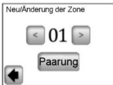
Jetzt ist der Hauptempfänger (gewöhnlich V23) des jeweiligen Zimmers/Zone mit Betätigung der Paarungstaste für 3 Sekunden in den Modus „RF init“ umzuschalten – die LED Diode auf der gepaarten Einheit beginnt grün zu leuchten.
