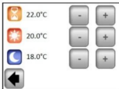
Die gewünschten Temperaturwerte mittels (+) und (-) einstellen. Mit entsprechender Taste im unteren Teil des Displays wird die Änderung bestätigt oder aufgehoben.
