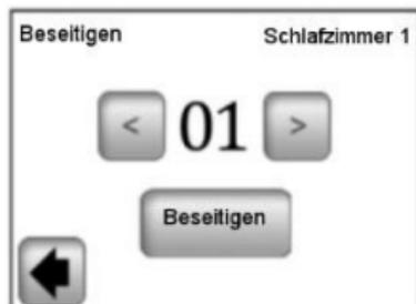
Mit den Tasten (<) oder (>) die zu löschende Zone auswählen und die Taste „**Beseitigen**“ betätigen. Um ungewünschtes Löschen der Zone zu verhindern, ist die
