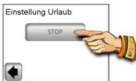
**Bemerkung:** Im Modus „Zu Hause“ wird der grundlegende Bildschirm angezeigt, welcher Zugang zu allen Funktionen ermöglicht, und zwar um das Symbol „Urlaub“ mit dem Rückkehrdatum ergänzt. Vorzeitige Beendigung der Funktion ist mit Betätigung des Symbols und der nachfolgend angezeigten Taste „STOP“ möglich:
