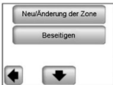
Mit Betätigung der Taste „**Neu/Änderung der Zone**“ ist es möglich, eine neue Zone zuzufügen oder eine der bestehenden Zonen zu modifizieren/ändern. Die Paarung ist im Kapitel 2.3 beschrieben.
