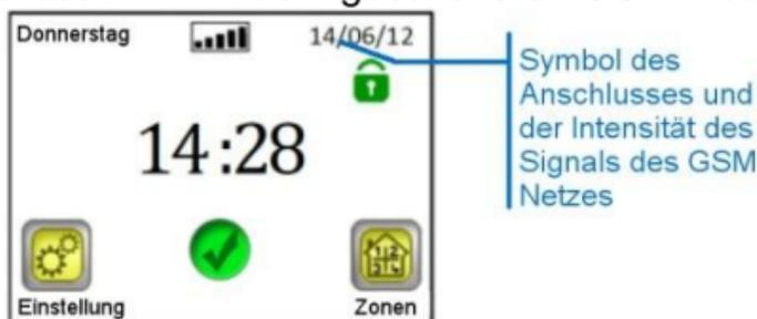
Die Einstellung der GSM Kommunikation ist nur mit dem angeschlossenen GSM Modul V27 möglich (drahtloser Anschluss oder mittels Kabel).
