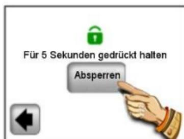
Das Absperren des Displays wird mit roter Ikone des Schlosses signalisiert. Mit Betätigung dieser Ikone und ihrer gedrückt Haltung für 5 Sekunden wird das Display aktiv.
