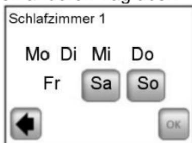
Nach Programmieren aller Tage die Taste „OK“ betätigen, wodurch das Programm bestätigt und gespeichert wird.
